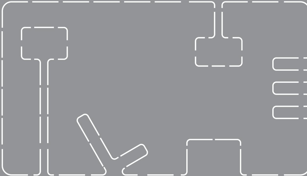
“living in a box” wurde mit 8 verschiedenen Elementen realisiert. Dazu notwendig waren lediglich 3 Presswerkzeuge, da durch die Entwicklung eines 40er Rasters mehrere Elemente aus einem Werkzeug resultieren.
